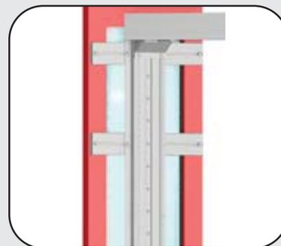
Fissaggio dell'anta direttamente sul montante della colonna
