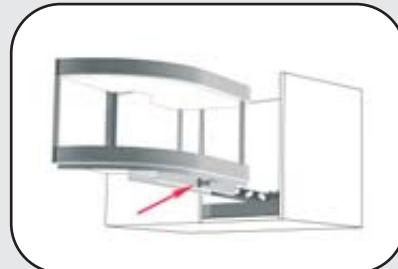
Elemento con fissaggio dell'anta frontale
